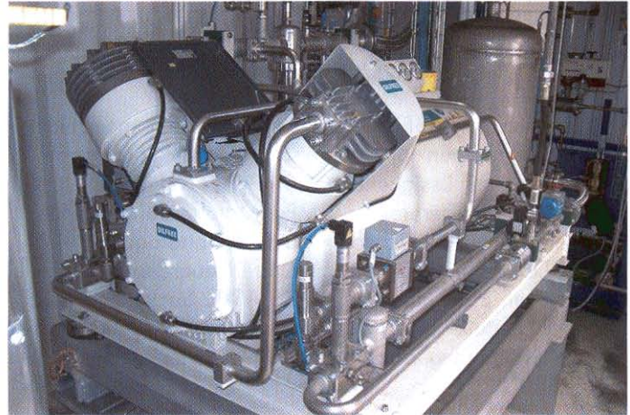
Bild 3: Komprimiert das Synthesegas: Ölloser Kolbenkompressor VTOG (Durchfluss: 60 m 3 /h)
