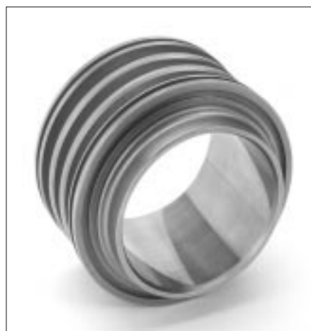
Bild 3: Die rostfreien Zylinder-Laufflächen werden durch ein chemisches Verfahren beschichtet, auf Spezialmaschinen feinstgehont, thermisch vergütet und gehärtet.
