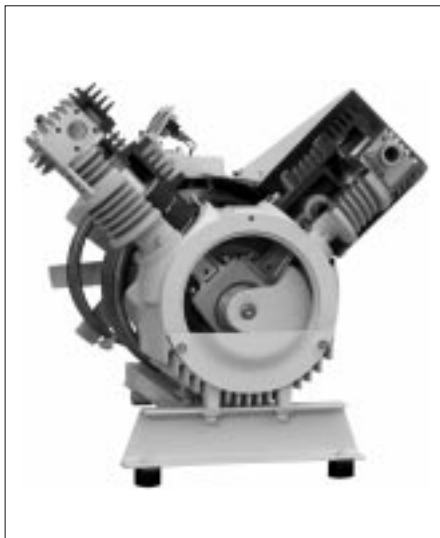
Bild 1: Schnitt durch einen öllosen Kolbenkompressor
