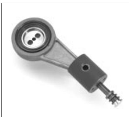
Bild 2: Einbaufertige Kolben-Pleuel-Baugruppe mit speziellen Wälzlagern und einer großen Kolbenführung auf Teflonbasis. Aufgrund der Aluminium-Konstruktion und des kleinen Hubes entstehen nur sehr kleine Massenkräfte. Die Kompressoren laufen daher äußerst vibrationsarm. Ein Fundament ist nicht erforderlich.
