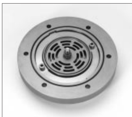
Bild 5: Kombiniertes Saug-/Druckventil aus rostfreiem Stahl. Aufgrund großer Strömungsquerschnitte ergeben sich sehr kleine Druckverluste. Die Ventile arbeiten reibungslos.
